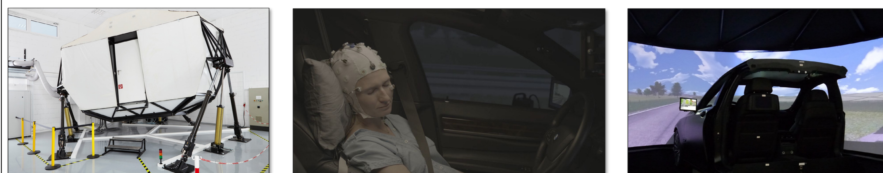
Dynamischer PKW-Simulator mit automatischer Sitzverstellung in Schlaf- und Fahrposition
